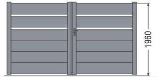
S3 - Lames de 300 avec 2 ajour de 50mm entre 2 lames.
