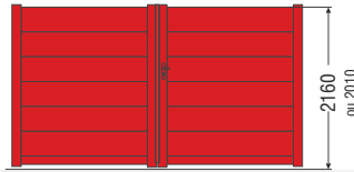
S2 - Lames de 300 avec 1 lame en partie basse de 100mm ou 150mm.
