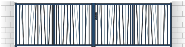
BATTANT - Version n.º 3: BARREAUDAGE NON DÉBORDANT ET ENTRE TRAVERSES
