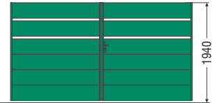
Y3 - Lames de 300 avec 2 ajour de 50mm entre 2 lames.
