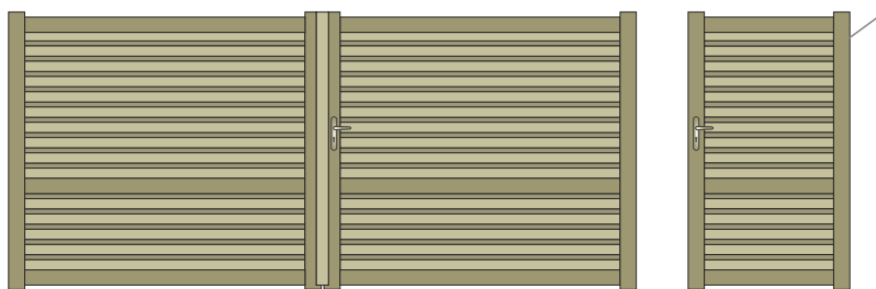
LAMES «Z» PERSIENNÉES (HORIZONTALES OU VERTICALES) AVEC TRAVERSE CENTRALE POUR MOTORISATION
